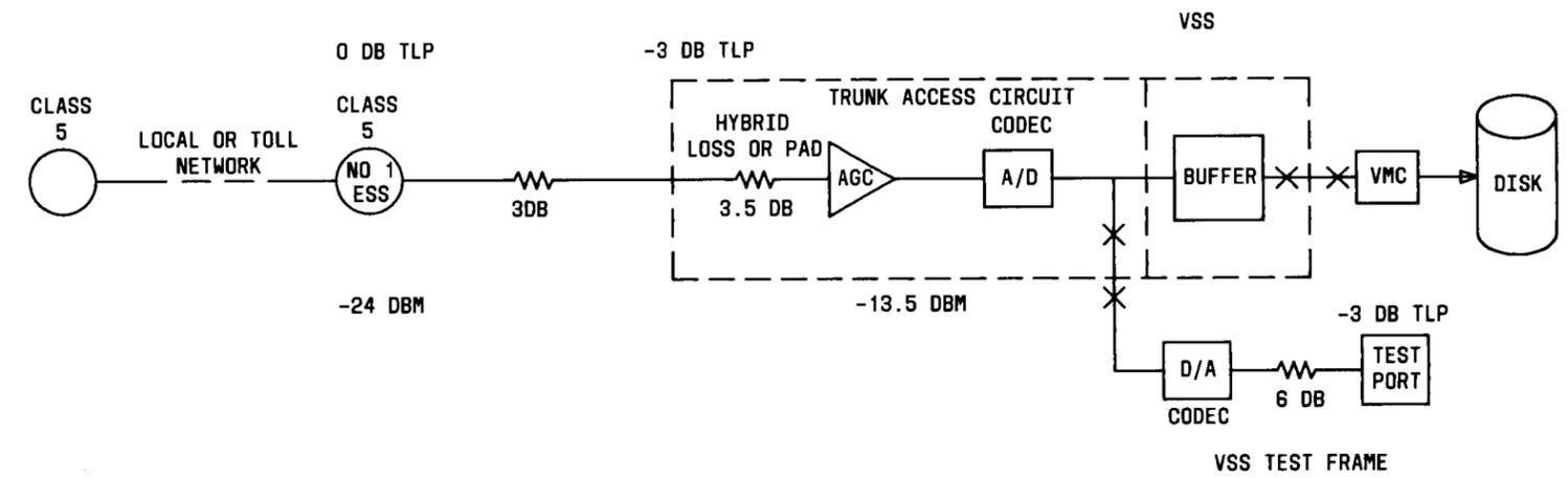
Fig. 3—VSS Record Mode Fig. 4—VSS Playback Mode
