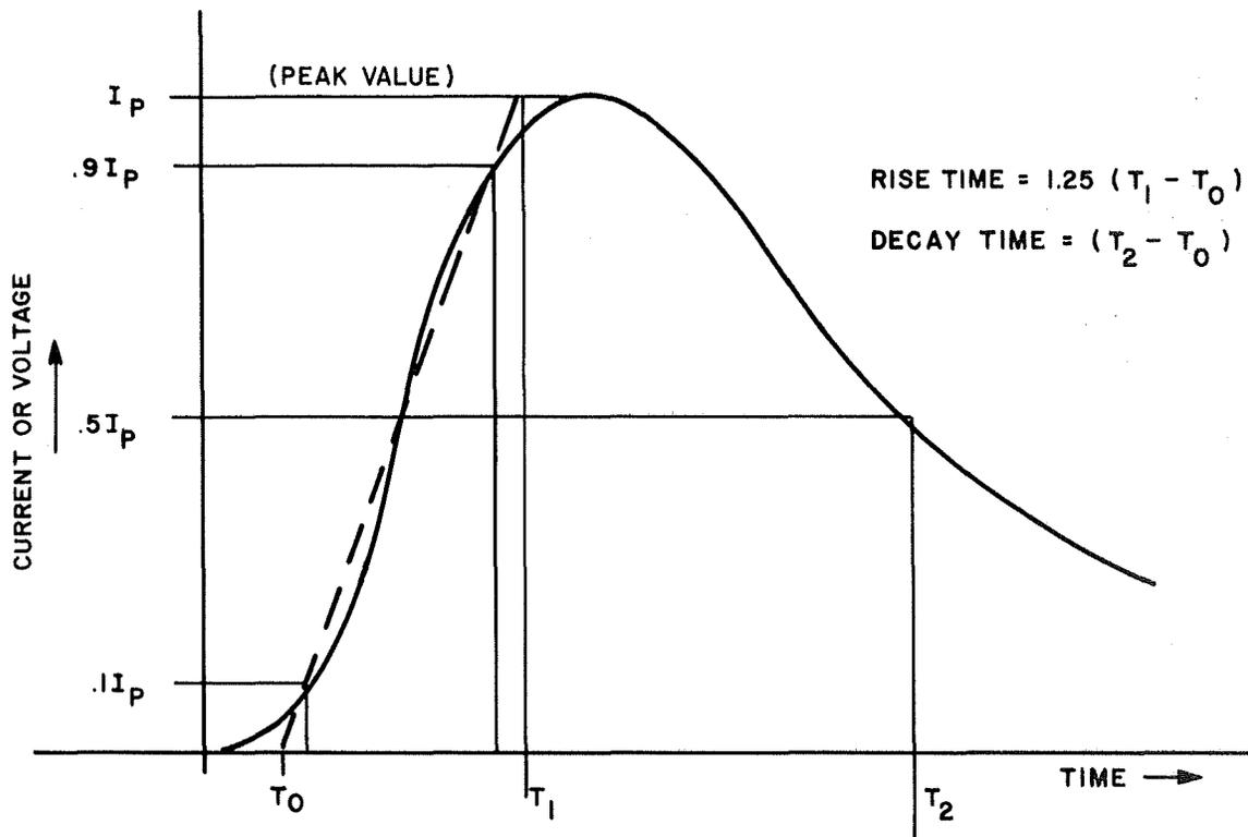
FIG. 1 - DEFINITION OF DOUBLE EXPONENTIAL IMPULSE WAVEFORM OF DURATION  $a \times b$  SECONDS
